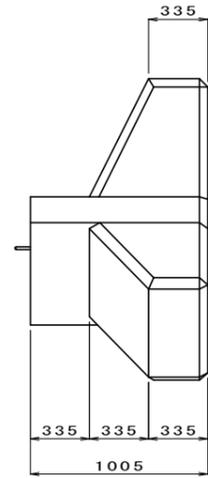
□半ブロック脱型用吊鉄筋図
